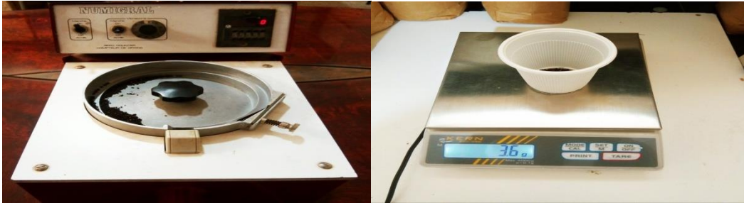
شكل 13: ميزان الكتروني لوزن البذور شكل 14: جهاز عد البذور Numigral
